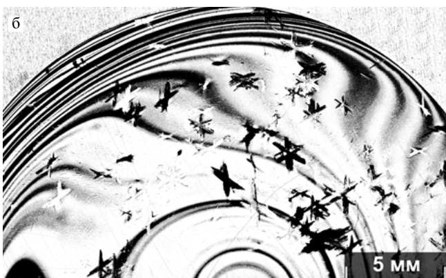
Рис. П93 Фрагмент доменной структуры кристалла с второй фазой на фоне отрицательного (а) и положительного (б) доменов в кристалле \text{LiNbO}_3:\text{Er} ( [\text{Er}] = 3,6 \text{ мас\%} в расплаве). После ТО. Z-срез
