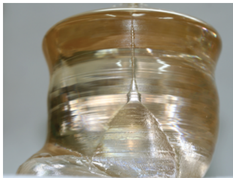
Рис. П3 Разрастание ребра, отражающего симметрию кристалла, в плоскость на кристаллической буле. На примере крупногабаритного кристалла \text{LiNbO}_3:\text{Zn} ( [\text{ZnO}] \approx 5 мол% в расплаве), прямое легирование
