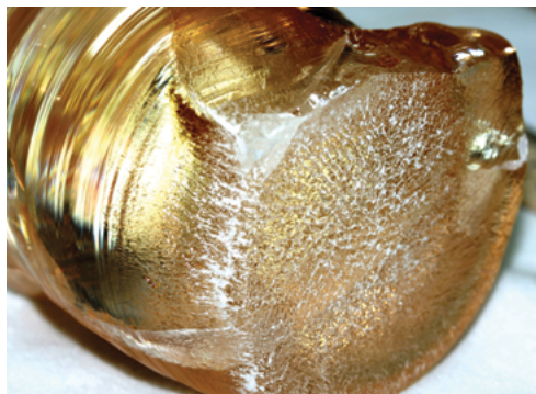
Рис. П4 Ячеистый рост в нижней части крупногабаритной були кристалла \text{LiNbO}_3:\text{Zn} ( [\text{ZnO}] \approx 5 мол% в расплаве), прямое легирование
