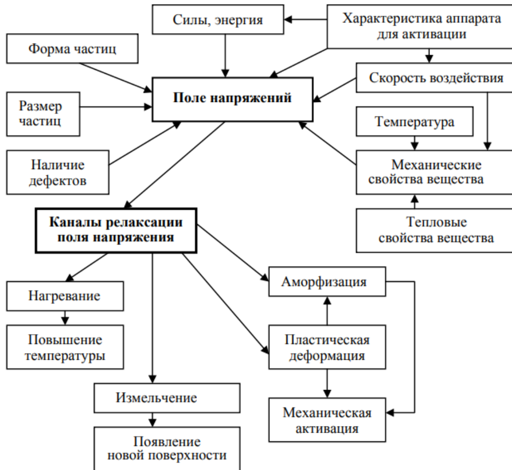
Рисунок 1.9 — Факторы, влияющие на поле напряжений и его релаксацию [98]
