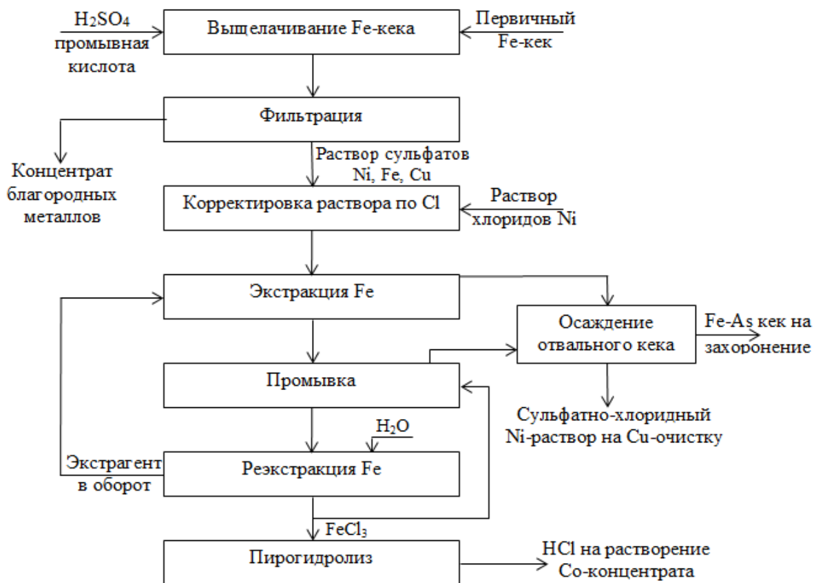
Рисунок 1.4 – Технологическая схема экстракционной переработки железистых кеков с одновременной утилизацией промывной серной кислоты [124]
