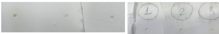
Рис. 3. Фрагменты керамических изделий после тестового нагружения внутренним давлением
