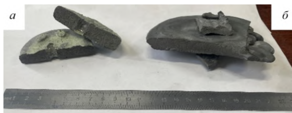
Рис. 1. Внешний вид образцов Dy: a — после процесса восстановления Са-термии; б — после рафинирующего вакуумно-дугового переплава
