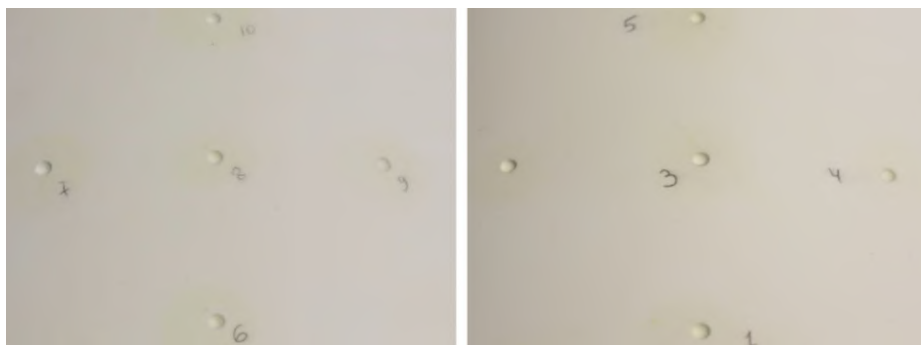
Рис. 2. Исходное состояние поверхности керамических изделий с нанесенными раковинами сферической формы
