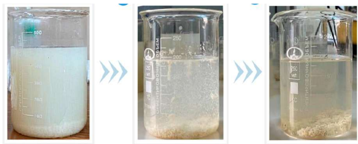
Рис. 3. Принцип коагулирующего воздействия исследуемого раствора сульфата железа, полученного при выщелачивании титаномagnetита раствором серной кислоты
