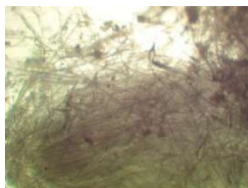
Рис. 4. Игольчатая структура волластонита, увеличение 50х
