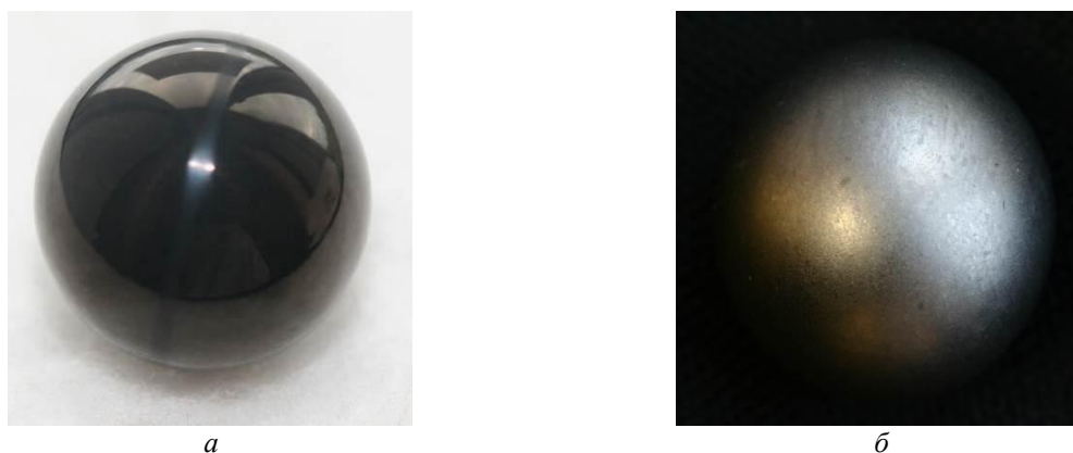
Рис. 2. Внешний вид сферического ротора с пояском до (а) и после (б) нанесения покрытия
