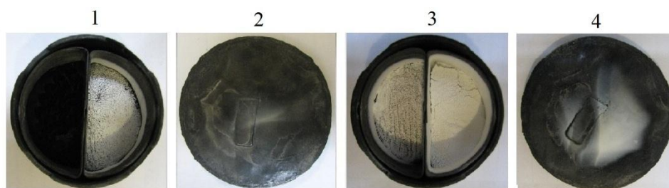
Рис. 1. Тигли с реакционной массой (1, 3) после восстановления и соответствующие им экраны (2, 4); прекурсоры: \text{MgW}_{0,3}\text{Mo}_{0,7}\text{O}_4 (левые тигли) и \text{CaW}_{0,3}\text{Mo}_{0,7}\text{O}_4 (правые тигли); остаточное давление в реакторе: 1, 2 — 5 кПа; 3, 4 — 10 кПа
