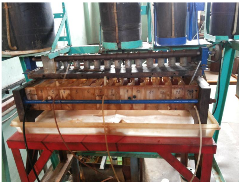
Рис. 3. Смесительно-отстойный 14-ступенчатый экстрактор
