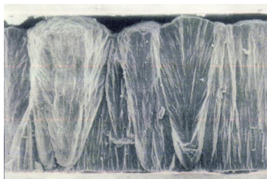
Рис. 7. Конусообразная структура пироуглерода
