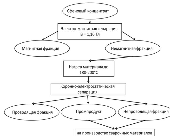
Рисунок 3 – Усовершенствованная схема радиационной очистки сфенового концентрата
